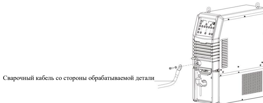
Рисунок 2-5 Схема подключения сварочного кабеля со стороны детали
