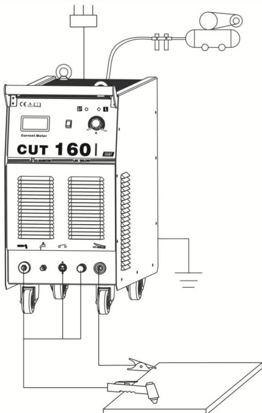
7. Подключите плазмотрон, кабель заземления, компрессор (CUT встроенный компрессор) как показано на рисунке. Кабель управления плазмотроном должен быть подсоединен к разъему на панели управления.
