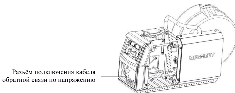
Рисунок 2-12. Подключение кабеля обратной связи по напряжению к стандартному блоку подачи проволоки
