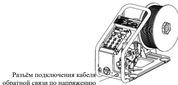
Рисунок 2-13. Подключение кабеля обратной связи по напряжению к облегчённому блоку подачи проволоки
