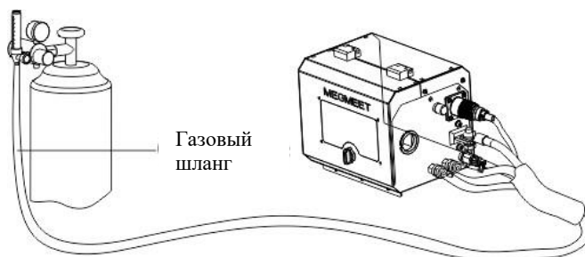
Рисунок 2-16. Подключение газового шланга к роботизированному блоку подачи проволоки
