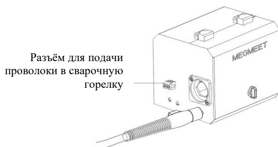
Рисунок 2-4. Подключение роботизированной сварочной горелки
